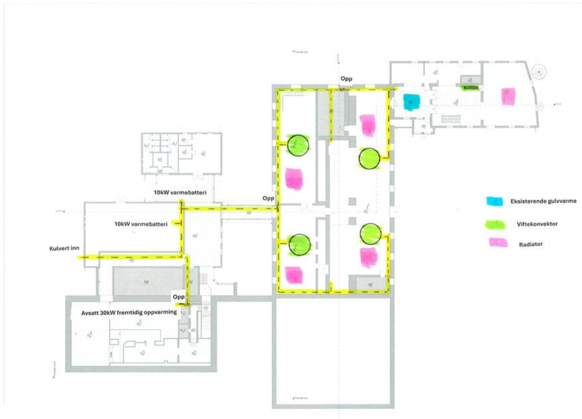
Figur 6. Underetasjen i Smeltehytta med serverings-, foredrags og utstillingslokale mm. Forslag til plassering av radiator, viftekonvektor, samt angitt område med eksisterende gulvvarme som skal kobles til.
